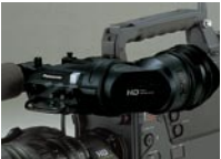
AJ-HVF21KG 50.8 mm (2 inches) HD EVF 59.94Hz/50Hz switchable
